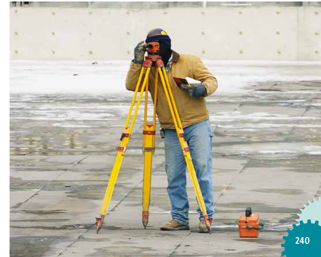
مهندس يستخدم ناظور المساحة لقياس الأبعاد.
