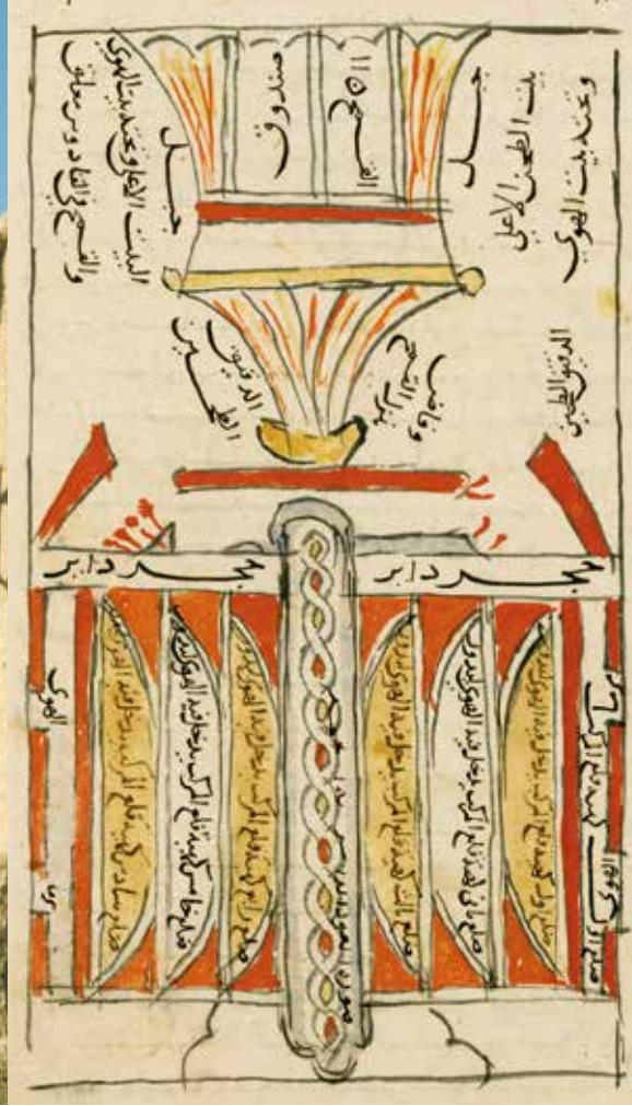
مخطوطة من القرن الرابع عشر للدمشقي، تبين مقطعاً عرضياً لطاحونة هوائية تدور ريش مروحتها الشاقولية على محور شاقولي.
